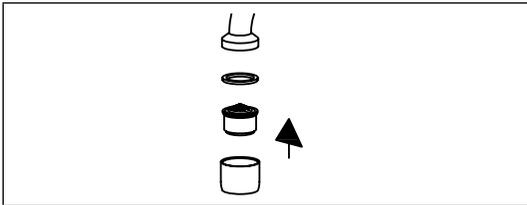
Рис. 8: Установка аэратора-распылителя
