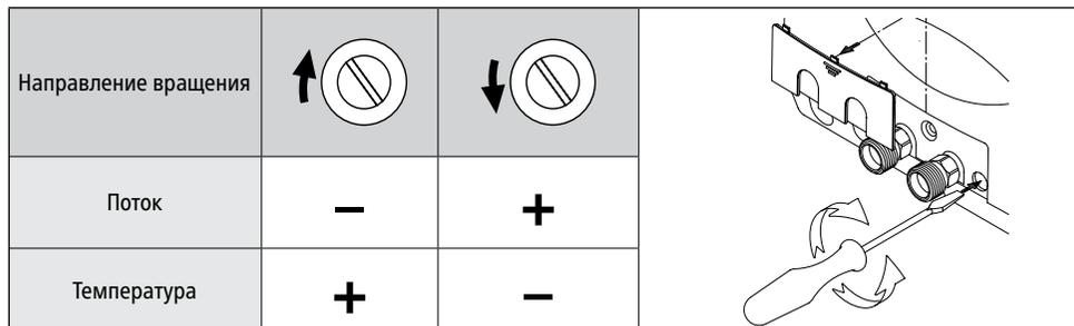
Рис. 11: Регулировка объемного расхода и температуры воды
