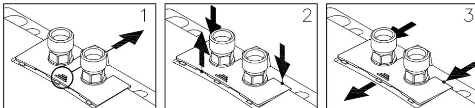
Рис. 10: Снятие крышки
