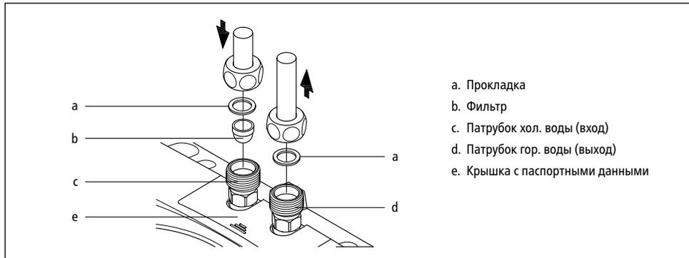
Рис. 6: Подключение подводки
