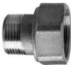
Трубы и арматура с трубной резьбой подсоединяются на отводы с помощью переходников (4) код 8791, имеющих с одной стороны внутреннюю резьбу М33х1.5, а с другой стороны наружную трубную резьбу 3/4".
