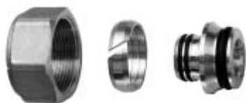
К отводам коллектора, имеющим метрическую резьбу 33x1.5, **концовками FAR** (код 6056) **напрямую присоединяются** металлопластиковые трубы 20x2, 20x2.25, 20x2.5, 25x2.5, 26x3. Ранее коллекторы MULTIFAR не имели отводов с непосредственным подсоединением труб 25x2.5 и 26x3. Подсоединение металлопластиковой трубы 26x3 дает возможность прямо от коллектора делать разводку стояков и магистралей с допустимым расходом до 1100 кг/ч, при котором скорость теплоносителя не превышает 1 м/с.
