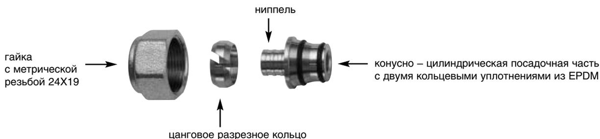
Концовки FAR для пластиковых труб отличаются от металлопластиковых nipples: на нем отсутствуют кольцевые резиновые уплотнения.
