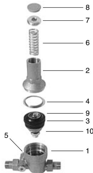
Специальная форма штока и внутренний профиль картриджа обеспечивают плавное обтекание клапана потоком жидкости без потенциально опасной турбулентности. Конструкция уплотнителя штока внутри картриджа может эксплуатироваться при высоких уровнях входного давления. Уплотнитель имеет тороидальную форму с кольцевыми уплотнениями. Он помещен между двумя шайбами Зегера, изготовленными из особого материала, которые предохраняют его от деформации.
