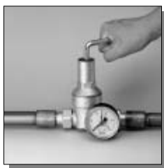
1. Снимите крышку с маркировкой FAR и отвинтите регулировочное кольцо с помощью монтажного ключа.
