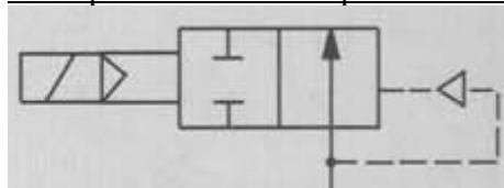
Детальный чертеж нормально закрытого клапана
